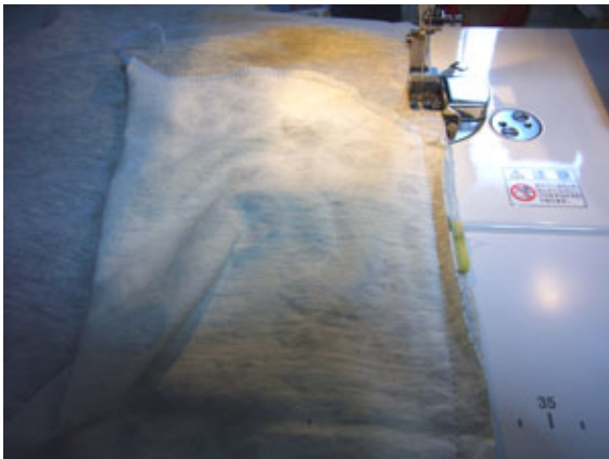
7. 前後身頃脇側を縫い合わせます。 (ポケットも形成して一緒に縫い合わせます) ロック始末して下さい
